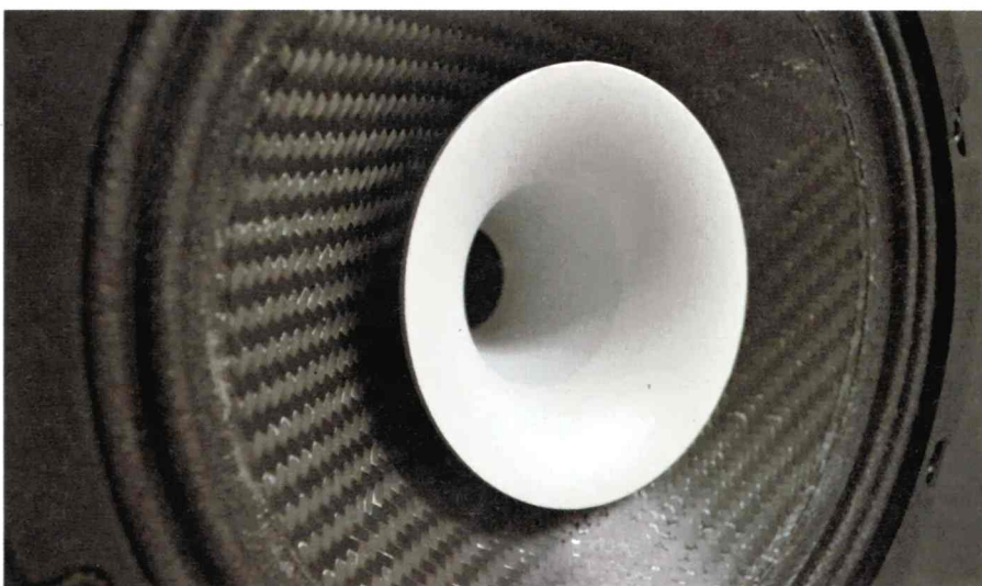
Die Membran der D80 ist aus Karbon gefertigt, das Horn des Hochtöners aus weißem Kunststoff.
