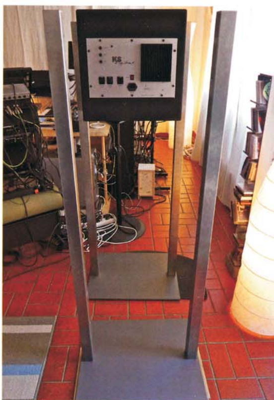
Die Rückseite eines C120-Coax in der optional verfügbaren Aufhängungskonstruktion von KSDigital.
