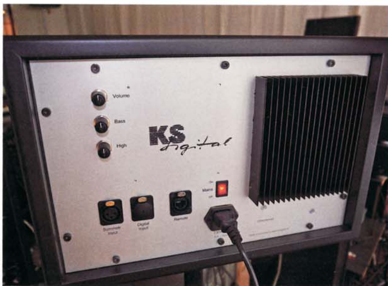
Anschlüsse und Regler auf der Rückseite des KSdigital ADM22
