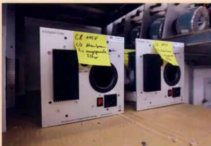
Aktiv-Elektronik-Module des analogen Zwei-Wege Coax-Monitors C8.
